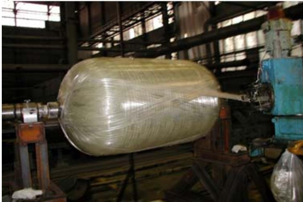
Соңғы кездері компьютерлік жүйемен басқарылатын қондырғылар жасалып жатыр. Бұндай қондырғылар трубо тәріздес, бүгілісі бар, формасы дұрыс емес және геометриясы курделі заттарды алуға болады.
